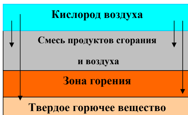
Рис. 2.4. Диффузия кислорода в зону горения твердого вещества (гетерогенное горение)
