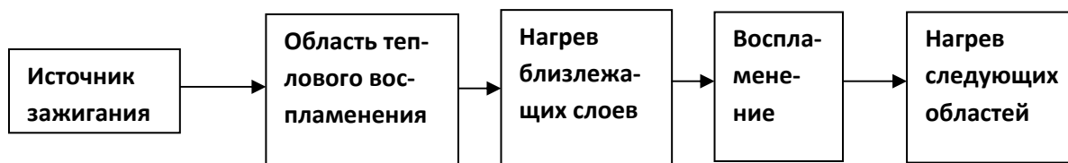
Рис. 2.5. Тепловой механизм распространения пламени
